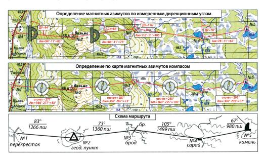
Рис. 154. Составление схемы при движении по азимутам
