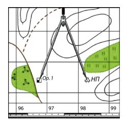
Рис. 159. Измерение расстояний на карте циркулем-измерителем
