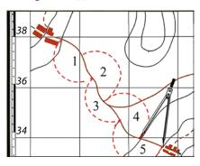
Рис. 161. Определение расстояния «шагом» циркуля
