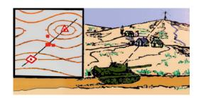
Рис. 166. Определение своего местоположения по створу
