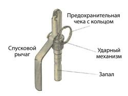
Рис. 140. УЗРГМ (унифицированный запал ручной гранаты модернизированный)
