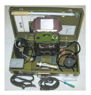
Рис. 175. Измеритель мощности дозы ДП-5В
