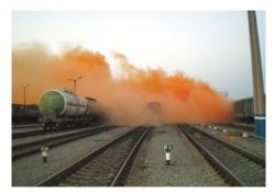
Рис. 183. Поступление СДЯВ из емкости в атмосферу при аварии на железнодорожной станции
