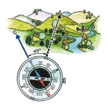
Рис. 151. Определение магнитного азимута по компасу
