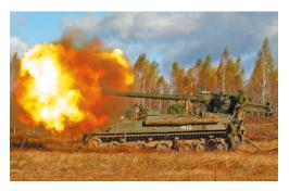
Рис. 68. Самоходная артиллерийская установка 2C5 «Гиацинт»
