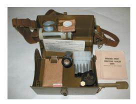
Рис. 179. Войсковой прибор химической разведки
