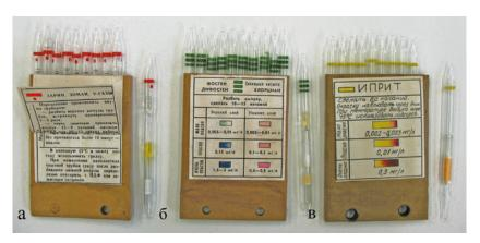
Рис. 180. Индикаторные трубки в кассетах: a — ИТ- 44; б — ИТ-45; в — ИТ-36
