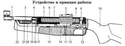
Рис. 115. Пневматическая винтовка: 1 — ствол; 2 — прицел; 3 — ось ствола; 4 — прокладка ствола; 5 — ствольная коробка; 6 — поршень; 7 — боевая пружина; 8 — колодка спускового механизма; 9 — штифт колодки; 10 — ложа; 11 — задний винт ложи; 12 — спусковой крючок; 13 — шептало; 14 — рычаг блокировки; 15 — рычаг взведения; 17 — манжета; 18 — шарнир; 19 — клин; 20 — ригель; 21 — пружина ригеля; 22 — ось шарнира
