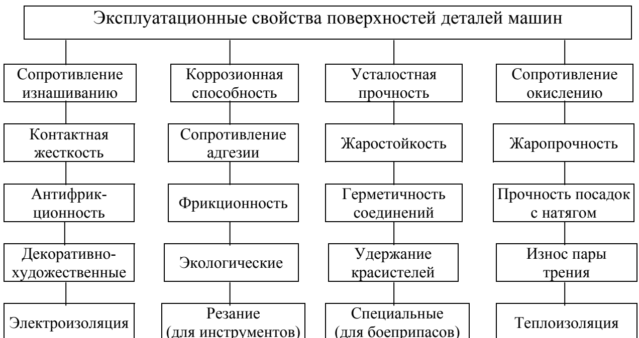
Рисунок 10.35 – Эксплуатационные свойства поверхностей [33]
