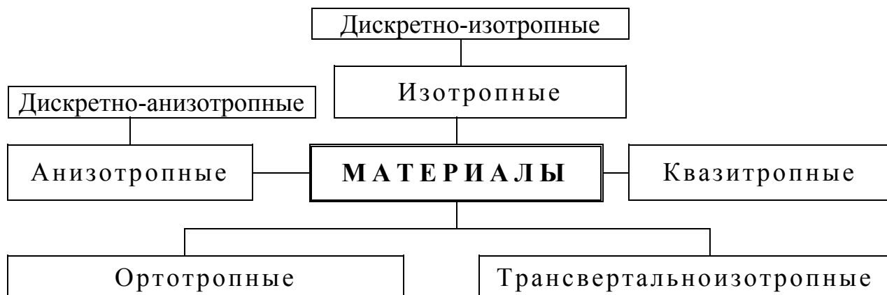
Рисунок 3.1 – Общая классификация материалов по единству физико-механических свойств [14]
