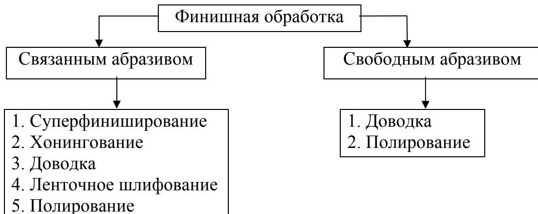
Рисунок 9.4 – Классификация видов финишной обработки
