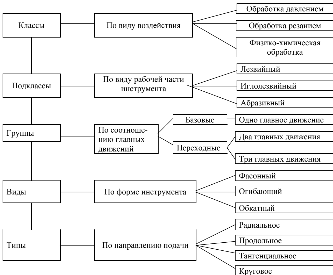
Рисунок 22.1 – Классификация способов механической комбинированной обработки
