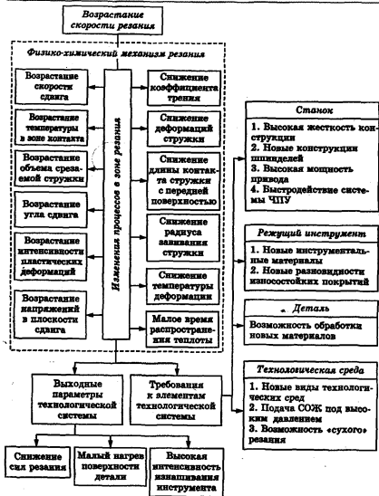
Рис. 14.3. Система резания в условиях НСР
