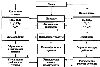
Рис. 9.2. Некоторые направления действия СОТС при резании металлов (R — радикалы)
