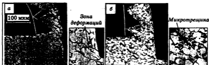
Рис. 14.15. Корни стружек при сверхскоростном резании титанового сплава Ti6Al4V:
