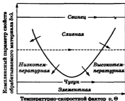
Рис. 3.12. Влияние температурно-скоростного фактора и свойств обрабатываемого материала на характер стружкообразования
