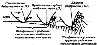
Рис. 11.23. Изменения механизма стружкообразования при шлифовании керамики
