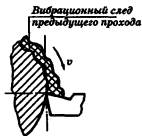
Рис. 5.28. Схема резания по следу предыдущего прохода
