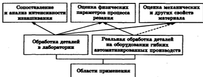
Рис. 11.2. Способы оценки обрабатываемости и области их применения (штриховая линия означает необходимость контроля на загрузочной позиции технологической системы)
